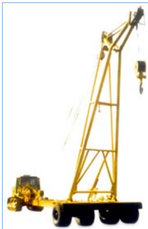
Применяются для монтажа и демонтажа бурового и нефтепромыслового оборудования, производства погрузочно-разгрузочных работ, перемещения грузов.
